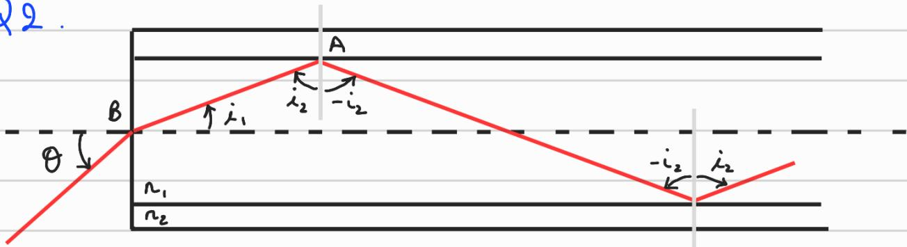
Q3. Le rayon est guidé dans la fibre si  $n_1 \sin i_2 > n_2$  (réflexion totale en A), c'est à dire qu'il n'existe pas d'angle  $i_3$  vérifiant  $n_1 \sin i_3 = n_2 \sin i_3$ .
