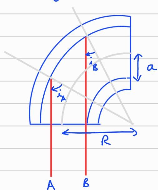
$i_A > i_B$  donc si  $i_B > i_{lim}$
