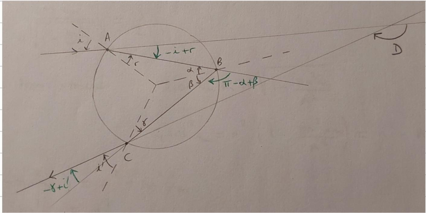
Q7. les rayons émergents sont parallèles quel que soit l'angle d'incidence  $i$  si la déviation  $D$  est indépendante de  $i$ .
