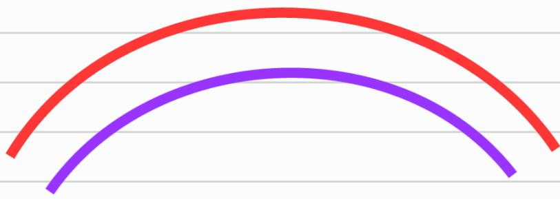
Remarque : un arc en ciel secondaire est parfois observé au dessus de l'arc primaire, il correspond au cas où les rayons effectuent une réflexion supplémentaire dans la goutte.
