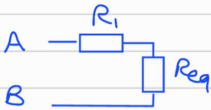
$$\text{avec } \frac{1}{R_{eq}} = \frac{1}{R_2} + \frac{1}{R_3} = \frac{R_2 + R_3}{R_2 R_3}$$
