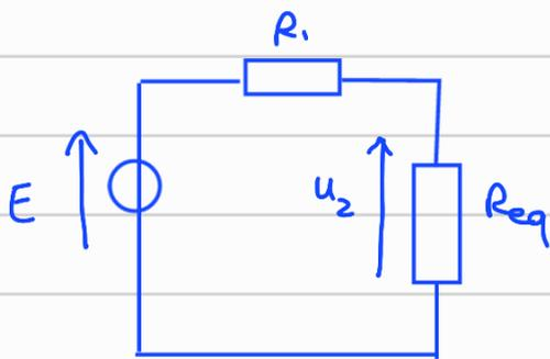
$$\text{avec } \frac{1}{R_{eq}} = \frac{1}{R_2} + \frac{1}{R_3 + R_4}$$
