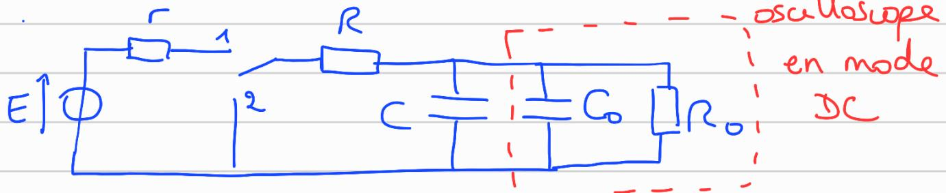
Q8 Pour des condensateurs en parallèle, on ajoute les capacités pour avoir la capacité équivalente :  $C_{eq} = C + C_0$ .
