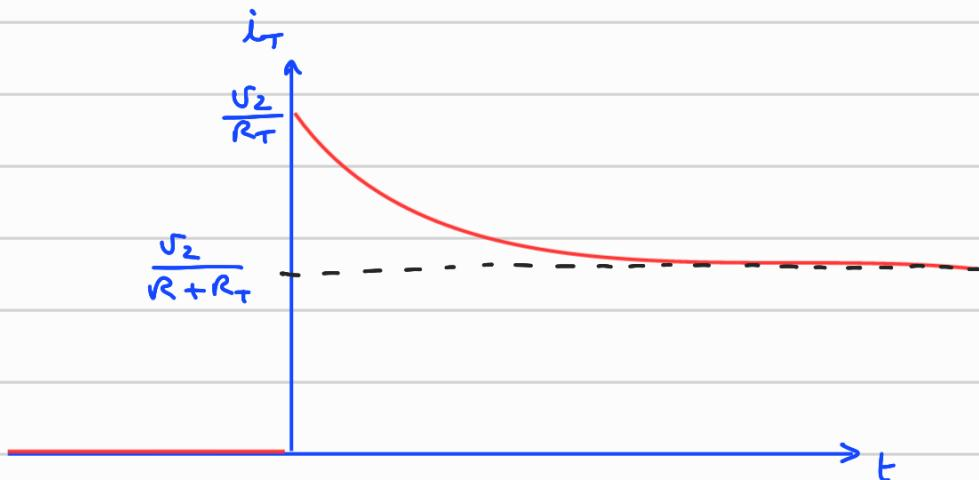
L'intensité  $i_T$  subit une discontinuité à la fermeture de l'interrupteur. Elle passe brusquement de  $i_T = 0$  A à  $i_T = \frac{U_2}{R_T}$ , ce courant de forte intensité crée un flash lumineux.
