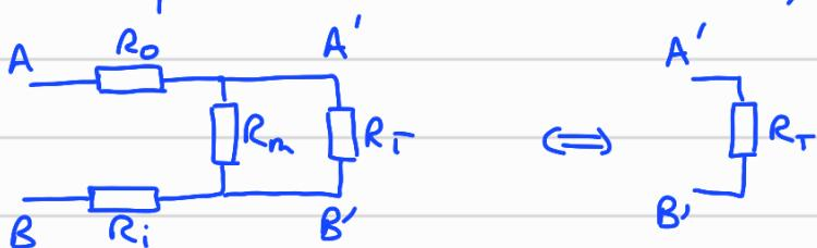
Déterminons la résistance équivalente dans le circuit de gauche :
