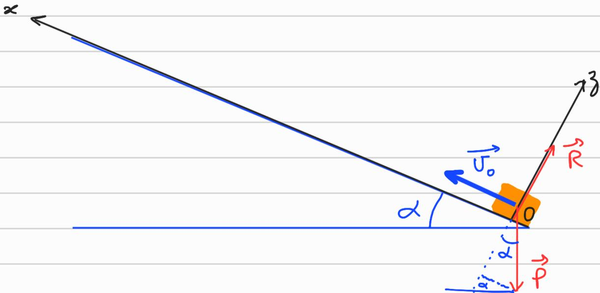
On applique le principe fondamental de la dynamique au système {brique} de masse constante dans le référentiel terrestre supposé galiléen:
