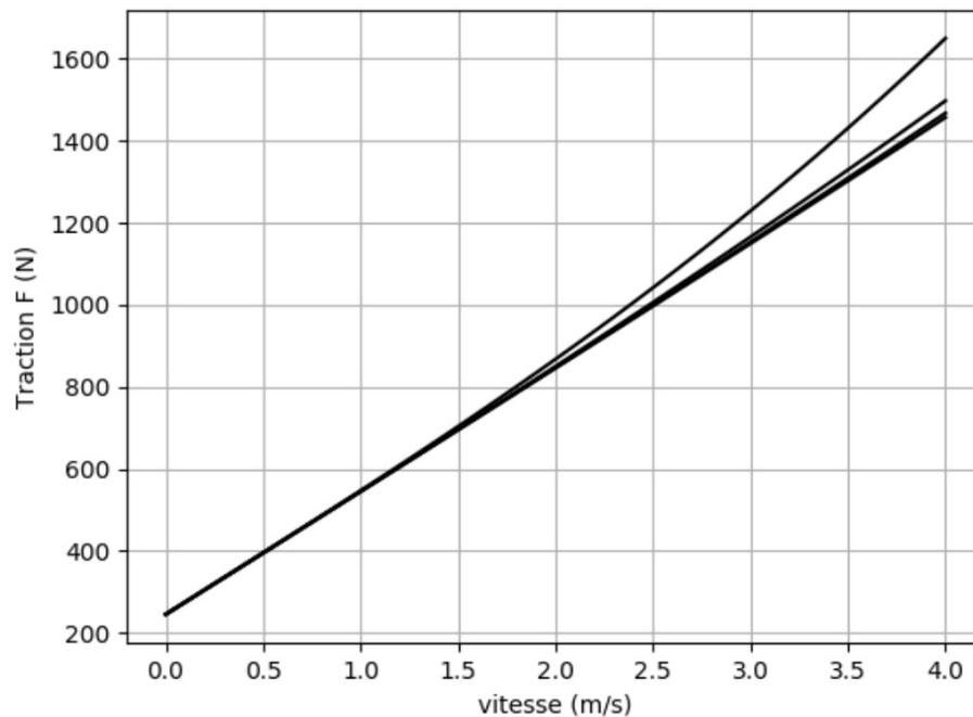
FIGURE 7 – Force de traction en fonction de la vitesse  $v_0$ , pour différentes valeur de rayons de courbure :  $R = 10$  m,  $20$  m,  $30$  m et  $40$  m.
