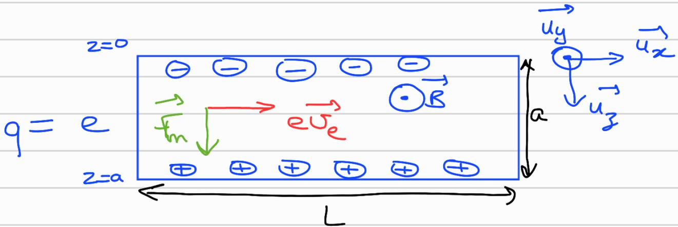
Q10 Si on relie la masse du voltmètre à la face inférieure et la borne de mesure à la face supérieure on mesure une tension  $u$ .
