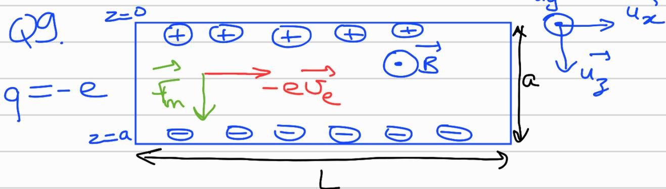
(le conducteur reste globalement neutre donc si les électrons se déplacent sur la face inférieure il apparaît un excédent de charge positive sur la face supérieure)
