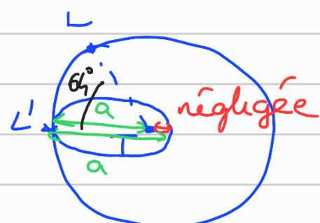
La fusée doit démarrer lorsque l'angle  $LTL' = 65^\circ$
