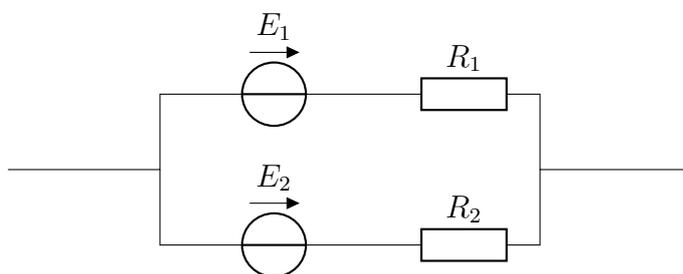
Déterminer la tension à vide  $E$  et la résistance interne  $R$  de l'unique générateur, qui serait équivalent au montage ci-dessus.
