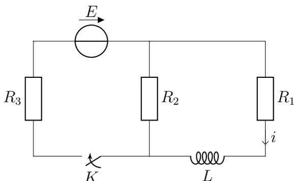
Initialement, la bobine n'est parcourue par aucun courant. À l'instant  $t = 0$ , on ferme l'interrupteur  $K$ .
