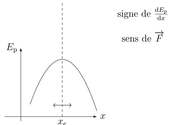
Cela se traduit par :  $\left(\frac{dE_p}{dx}\right)_{x=x_e} = 0$  (la force s'annule), et  $\left(\frac{d^2E_p}{dx^2}\right)_{x=x_e} < 0$  .
