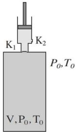
On s'intéresse au dispositif de pompage représenté ci-dessus, constitué d'un réservoir de volume  $V$ , initialement rempli d'air à la température  $T_0$  et à la pression  $P_0$  respectivement température et pression de l'atmosphère environnante. Cette enceinte est surmontée d'un cylindre muni d'un piston avec lequel elle communique par une valve  $K_1$ . Le cylindre communique lui même avec l'atmosphère au moyen d'une valve  $K_2$ .
