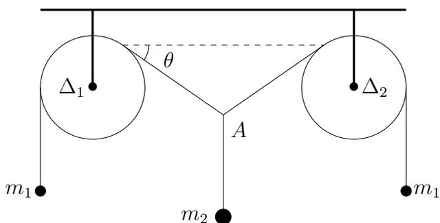
On s'intéresse au dispositif ci-contre, à l'équilibre et dans un plan. Les deux poulies sont identiques, de même rayon  $R$  et masse  $m_0$ , et les deux liaisons pivot avec le bâti sont modélisées par des liaisons parfaites : les frottements d'axe sont négligés. Les fils sont également tous supposés idéaux, c'est-à-dire qu'ils sont inextensibles et de masse négligeable. Enfin, on suppose que les fils ne glissent pas sur les poulies.
