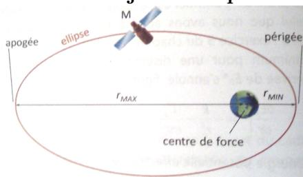
Une particule soumise à une force centrale attractive et newtonienne dont l'énergie mécanique est négative décrit une ellipse dont le centre de force occupe l'un des foyers.
