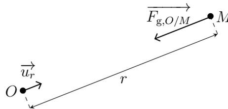
avec  $G =$  constante de gravitation universelle  $= 6,67 \times 10^{-11} \text{ m}^3 \cdot \text{kg}^{-1} \cdot \text{s}^{-2}$
