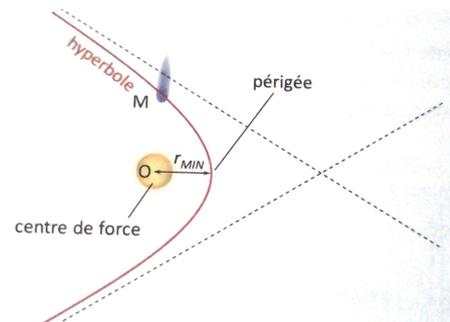
Une particule soumise à une force centrale attractive et newtonienne dont l'énergie mécanique est positive décrit une branche d'hyperbole dont le centre de force occupe le foyer le plus proche.
