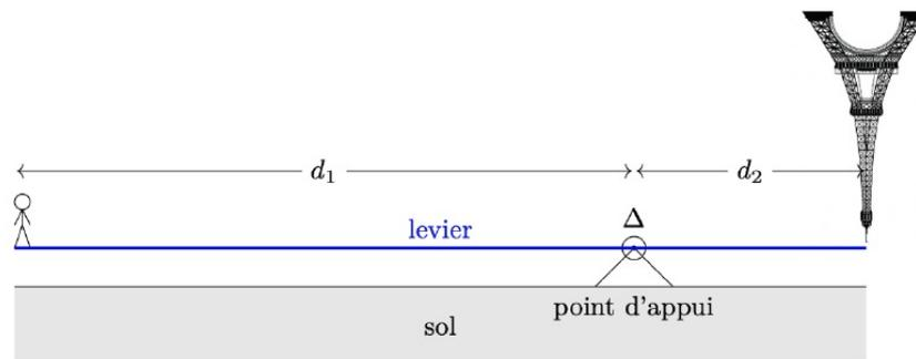
On cherche à déterminer quel levier est nécessaire pour soulever la tour Eiffel dans la situation ci-dessus. On représente la tour Eiffel à l'envers car on suppose pour simplifier que le point de contact entre le levier et cette dernière est ponctuel. Au niveau du point d'appui on suppose que la liaison est parfaite. Le système considéré est le levier dont on néglige la masse. On note  $m_1 = 100$  kg la masse de la personne,  $m_2 = 10000$  tonnes la masse de la tour Eiffel, et  $d_2 = 1$  m.
