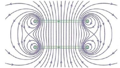
a) Dispositif des bobines de Helmholtz
