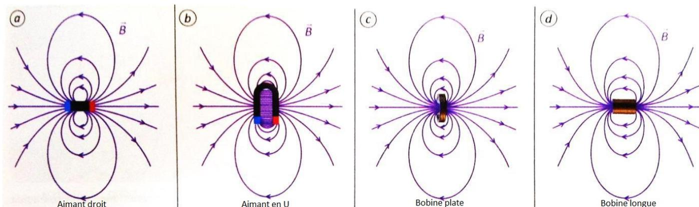
À distance d'observation grande devant la taille de la source du champ magnétique, on remarque que les cartes de champ d'un aimant droit, d'un aimant en U, d'une spire circulaire ou d'un solénoïde sont identiques. À grande distance, tous ces dispositifs sont équivalents à un dispositif de base : la spire circulaire, on dit qu'ils constituent des **dipôles magnétiques**. Afin de les comparer, on introduit leur moment magnétique  $\vec{m}$ .
