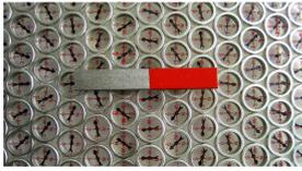
Si on place un ensemble de boussoles (c'est-à-dire des petits aimants) au niveau de l'aimant, on remarque de plus que ceux-ci s'orientent dans la même direction le long d'une ligne.
