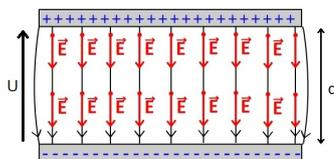
Le champ électrique est champ vectoriel. Entre les plaques d'un condensateur, il est uniforme, perpendiculaire aux plaques, dirigé du + vers le - et de norme  $E = \frac{U}{d}$
