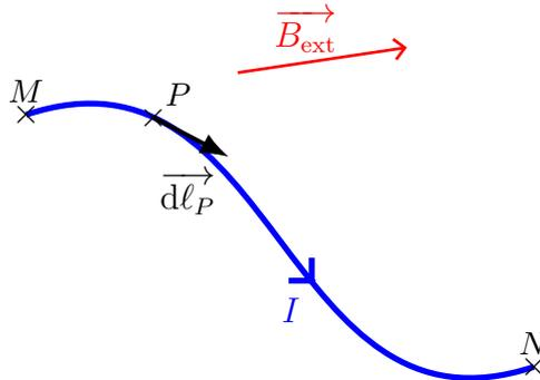
L'élément de conducteur  $d\vec{\ell}_P$  au niveau du point  $P$  subit la force élémentaire de Laplace  $d\vec{F}_{\mathcal{L}}(P)$  :
