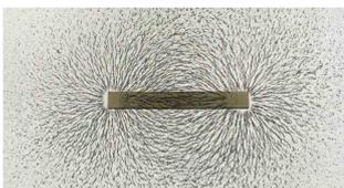
**Observations:** On peut visualiser le champ magnétique d'un aimant en disposant à sa proximité de la limaille de fer (= des petits « grains » de fer de forme allongée) : la limaille de fer dispose selon une géométrie particulière. Les copeaux de fer s'alignent allant d'un pôle à un autre.
